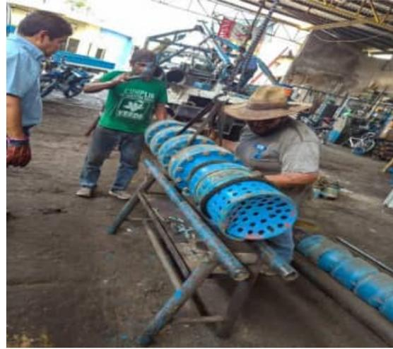
**5.-Equipamiento de pozo nuevo en la colonia Independencia:** Motor marca Navistar modelo 210 R.P.M. 2200 potencia 210 H.P. bomba marca Peerless Diam: descarga 4" long. Columna; 180 mts.
